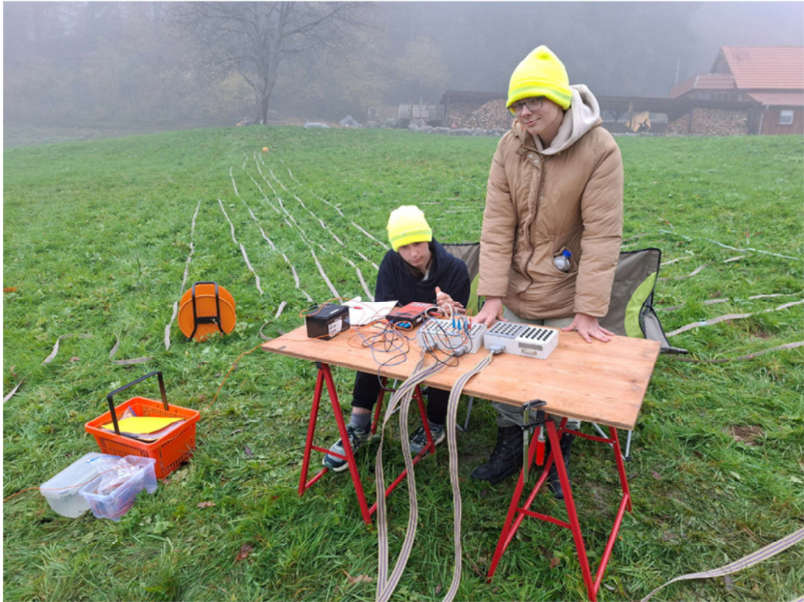
Datenerfassung: Geoelektrik-Messung: 74m lang mit 75 Elektroden: Abstand 1m, Wenner Array, 900 Einzelmessungen (Siméon, Luca)
