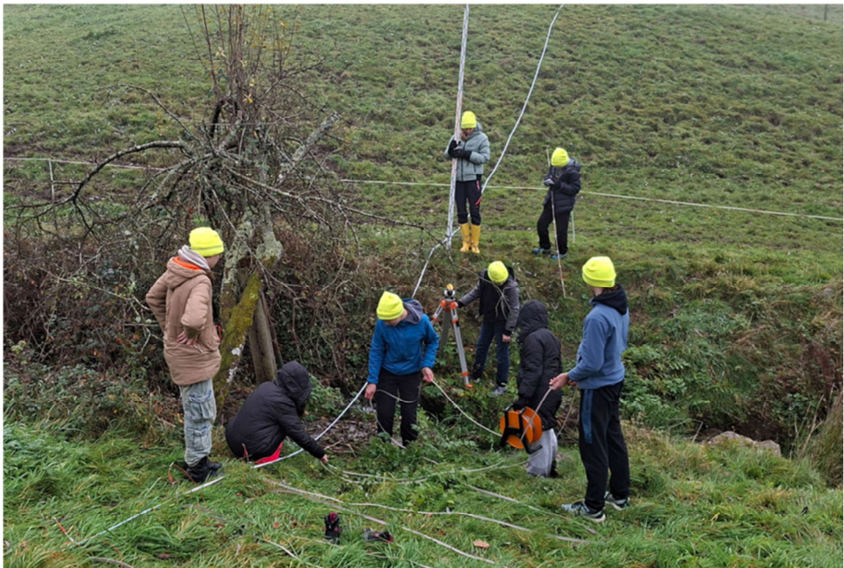
Ausbringen der Kabelauslage und anschließen der Elektroden
