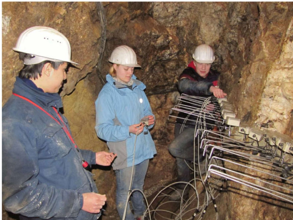
Installation der Elektrodenkette; Optimierung der Stromeinspeisung in die Stollenwand mit Hilfe eines Kontaktmittels; Jonathan, Sophie, Stefan (Moll)
