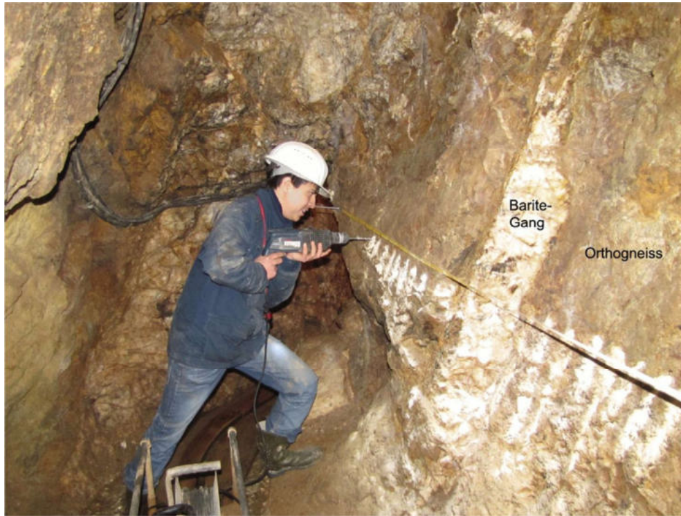
Bohrungen für Stromelektroden; Jonathan (Moll)
