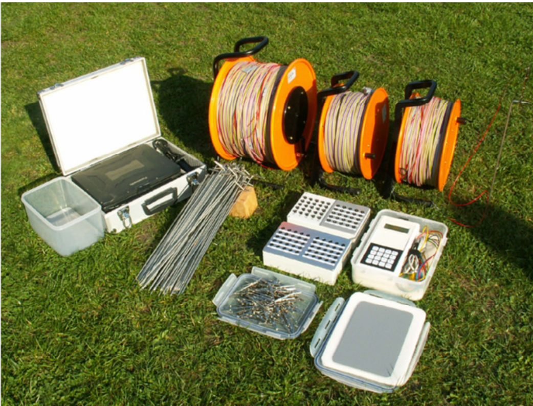
Manuelle Messanlage: Eigenbau von Schülern : Serielle Kabel 370m, 75 Edelstahlelektroden, Steckbox; Leihgabe Fa. Lippmann: Messgerät 4-Punkt Light: max. Sendestrom 50 mA; (Moll)
