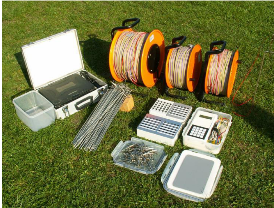
Messanlage: Eigenbau von Schülern: Serielles Kabel 370m, 75 Edelstahlelektroden, Steckbox; Leihgabe Fa. Lippmann: Messgerät 4-Punkt Light, max. Sendestrom 50 mAmp (Moll)
