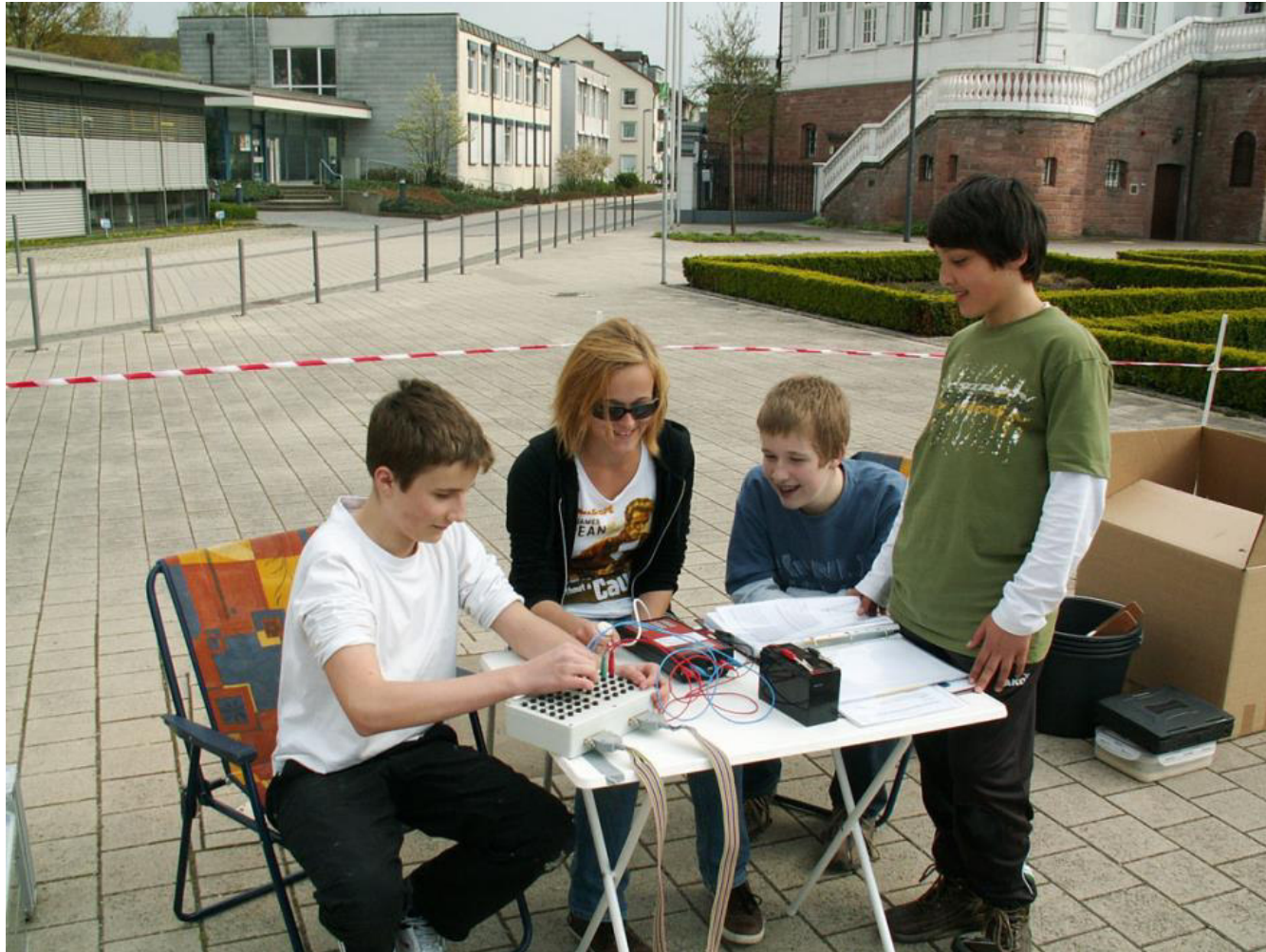
Messung_01: Geoelektrische Widerstandstomografie und Induzierte Polarisierung – Datennahme Jérôme David, Sophie Mätz, Stefan Beck, Alper Altay (Moll)
