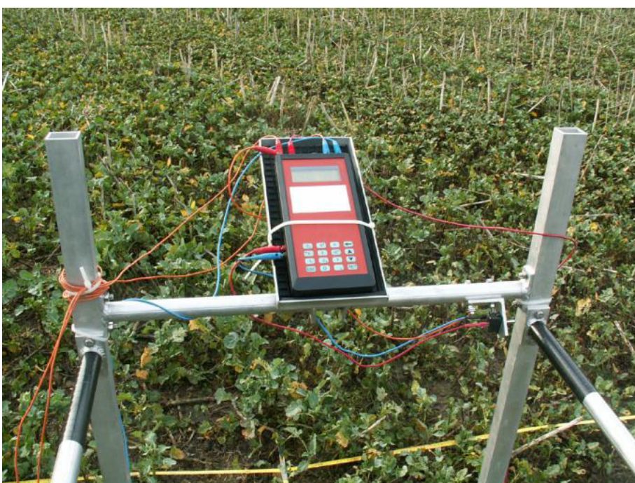
Geoelektrik-Messgerät „4-Punkt Light“ der Fa. Lippmann (Leihgabe)
